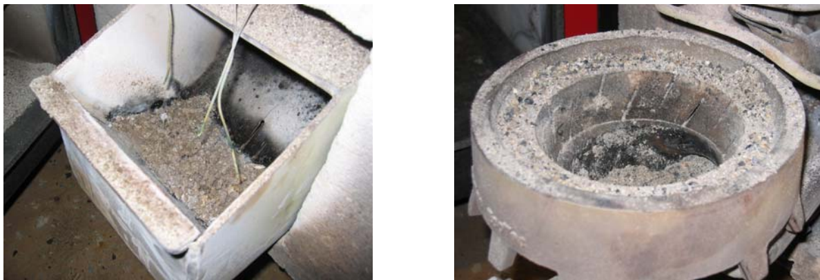
Figur 5. Brännarkoppen för den övermatade (vänster) respektive undermatade (höger) brännaren efter 24 h förbränningsförsök med asppellets.
