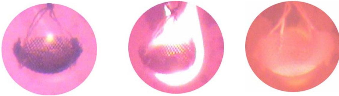
Figur 3. Illustration över förbränningsförloppet (t.v. torkning, mitten avgasning och förbränning av flyktiga ämnen och t.h. koksförbränning) hos en enskild träpellets.
